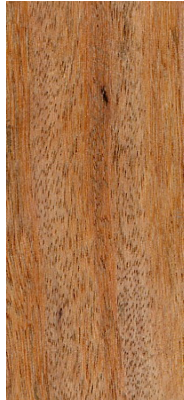
Débit sur faux quartier
